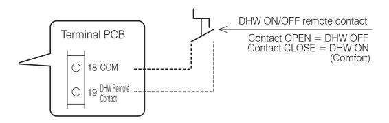
Figure 8-19: ON/OFF DHW production remote contact
